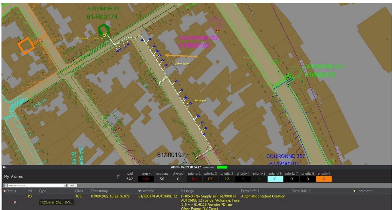
Figure 35 : Visualisation du module Outage Management System de Sibelga – Vue du réseau BT Les câbles sont colorés en fonction de la source d'alimentation. Un câble qui n'est plus sous tension apparaît en blanc.
