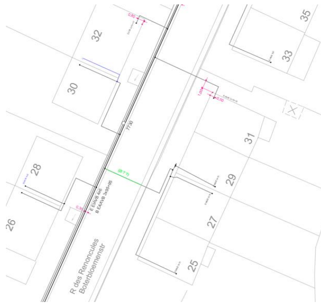
Figure 22 : Extrait de la base de données SIG de Sibelga – Plan de détail du réseau BT
